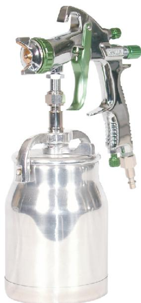
Pistolet de précision de construction solide et d'entretien facile. Léger, poignée ergonomique pour une bonne prise en main. Grande souplesse d'utilisation. La basse pression (inférieure à 1 bar) obtenue à la tête du pistolet permet : de réduire les brouillards de pulvérisation, la quantité de peinture utilisée, l'encrassement du poste de travail et améliore l'environnement de l'utilisateur.
