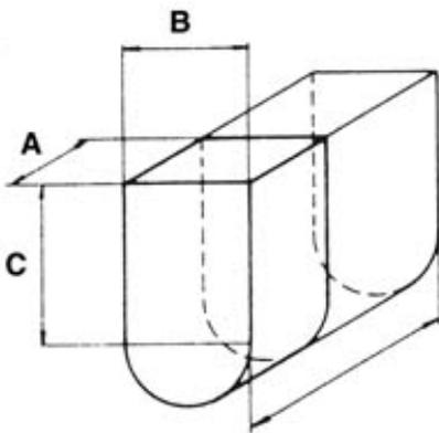
Dimensions des chaînes de fraisage Exemple 28 x 40 x 100 mm
